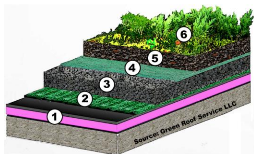
FIGURA 1 – Esquema da cobertura verde extensiva. Fonte: Green Roof Service LLC (2009)
